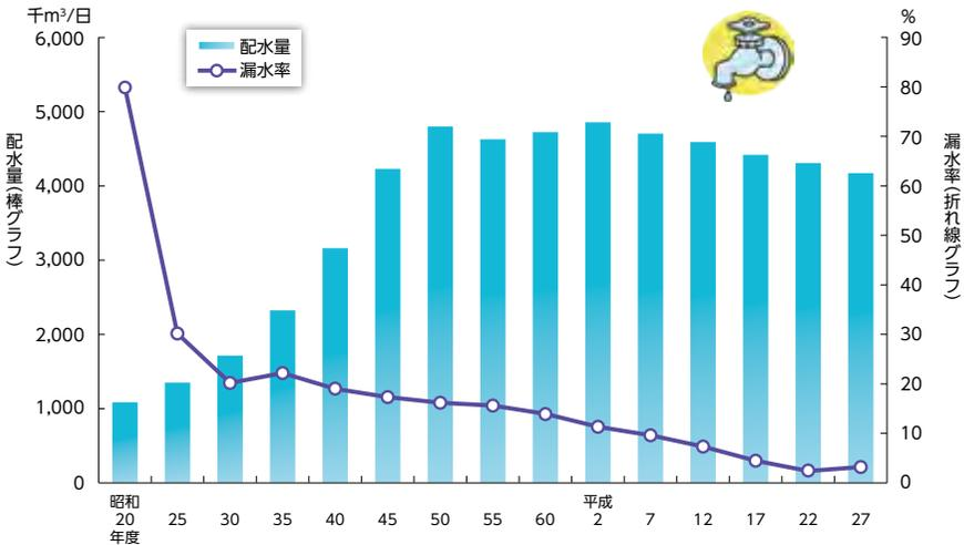
注) 漏水率 (%) = (年間漏水量 (m³) / 年間配水量 (m³)) × 100
